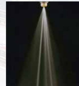
Kraftstoffsystem und Einspritzdüsen ohne Additive
